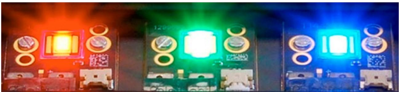
Con tali caratteristiche, uno schieramento di LED bianchi, o meglio di terne rosso verde blu, posto dietro ad una piastra diffondente, ha consentito di illuminare uniformemente lo strato a cristalli liquidi degli schermi LCD con una ampia gamma cromatica, ottenendo un rilevante mi-
